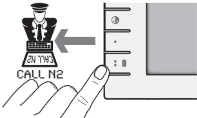
Нажмите и удерживайте не менее 2 секунд кнопку  $\Delta$ ; абонентское устройство издаст звуковой сигнал, красный светодиод включится, подтверждая передачу консьержу сигнала "Паника" и номера звонящего. Светодиод абонентского устройства останется включенным до тех пор, пока консьерж не позвонит абоненту.
