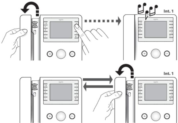
Для вызова одного из абонентских устройств снимите трубку и нажмите кнопку нужного абонентского устройства. Во время разговора между абонентскими устройствами вызов, поступающий с вызывной панели, будет отмечен с помощью звукового сигнала, повторяющегося каждые 5 секунд. 3 последовательных сигнала указывают, что вызов невозможен, потому что линия занята.
