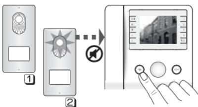
При наличии нескольких вызывных панелей последовательные нажатия на клавишу позволяют отображать все вызывные видео-панели.
