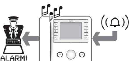
Включение контакта тревоги, подключенного к соответствующему входу абонентского устройства, активирует отправку сообщения консьержу, а абонентское устройство в течение 10 секунд будет подавать прерывистый акустический сигнал.
