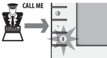
Включение светодиода Aux2 сигнализирует о том, что консьерж ожидает вашего звонка.
