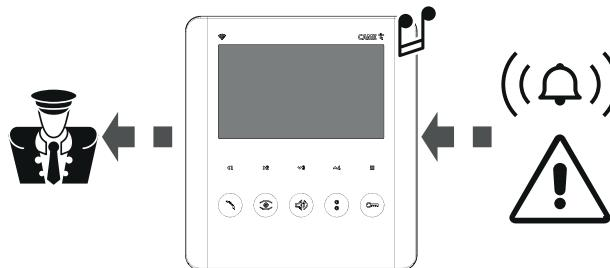
На этапе установки можно настроить контакты тревожной сигнализации на устройстве видеодомофона.
