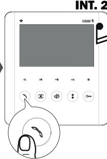
Для установки соединения с другим абонентским устройством (ИНТЕРКОМ) нажмите кнопку, присвоенную интересующему абонентскому устройству 1, 2 или 3.
