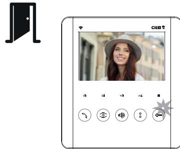
Эта функция позволяет отображать текущее состояние двери (открыта/закрыта) посредством светодиодного индикатора кнопки
