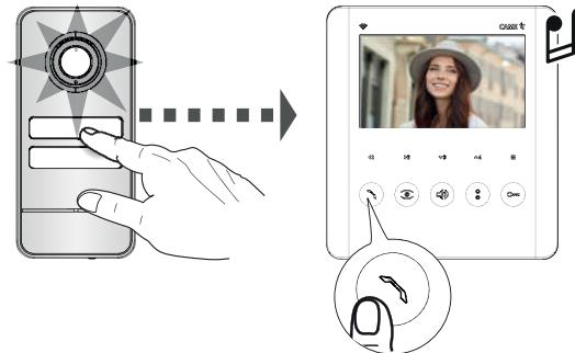
При нажатии кнопки вызова снаружи видеодомофон издает звуковой сигнал.
