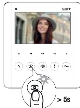
Эта функция позволяет автоматически открывать входную дверь при поступлении входящего вызова с вызывной панели. Соединение при этом не устанавливается, и вызов завершается автоматически. Эта функция рекомендована для частных офисов, бюро и студий.
