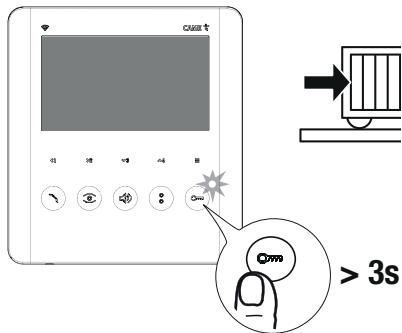
Функция открытия ворот позволяет активировать команду открытия/закрытия ворот и отобразить состояние (открытое/закрытое) посредством светодиодного индикатора кнопки
