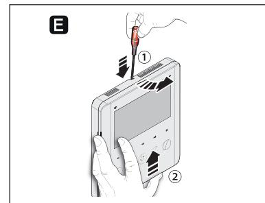
**A** Нажмите пластиковую кнопку и вытащите устройство из суппорта для настенного монтажа.
