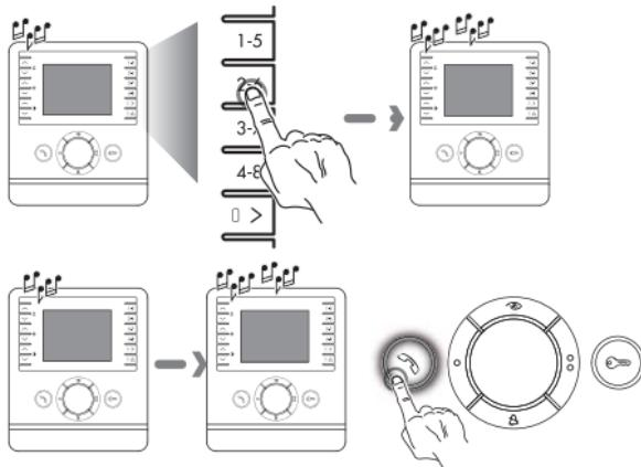
После выбора нужного абонентского устройствазывающее устройство подаст сигнал "свободная линия", а вызываемое устройство воспроизведет выбранную мелодию.
