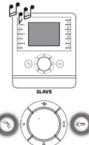
Если два или более абонентских устройства были настроены на ответ на один и тот же вызов, только на абонентском/их устройстве/ах "МАСТЕР" будет доступен предварительный просмотр изображения звонящего.
