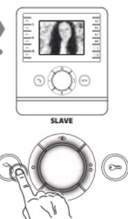
Нажмите клавишу для установления аудиосвязи с вызывной панелью.
