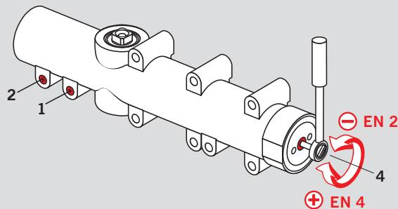
Скорость закрывания доводчика TS 72 регулируется двумя независимыми клапанами. К тому же, сила дохлопа настраивается с помощью рычага.
