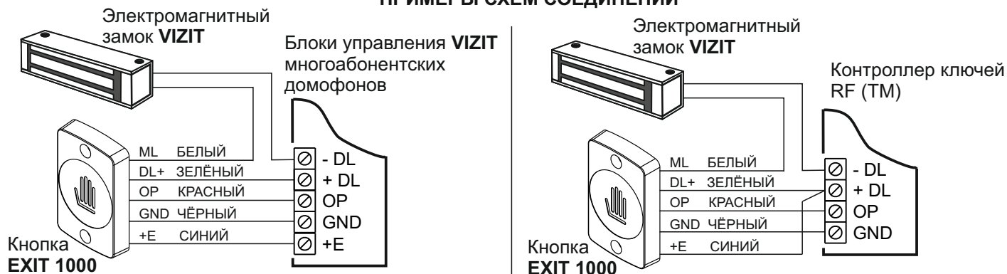
Схемы соединений кнопки с блоками управления VIZIT и контроллеров ключей
